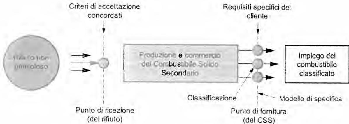
Figura 1 – Processo di produzione CSS previsto dalla Norma UNI 15359
