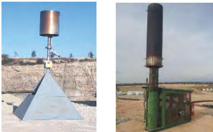
**Figura 16 – Torcia statica di combustione biogas con piedistallo (a sx) e torcia dinamica**
