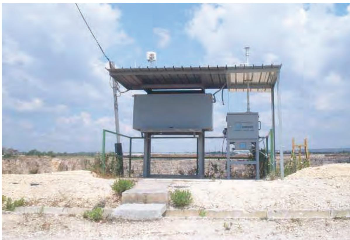
**Figura 11 – Centralina di monitoraggio aria n°2**
