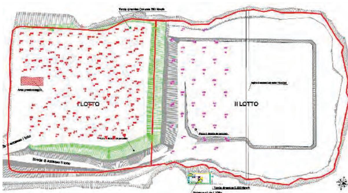
**Figura 15– Planimetria pozzi captazione biogas I e II lotto e torce dinamiche**
