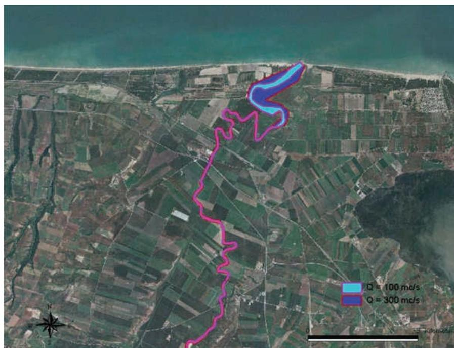
*Figura 4-8 Aree inondabili per  $Q = 100 \text{ mc/s}$  e  $Q = 300 \text{ mc/s}$*
