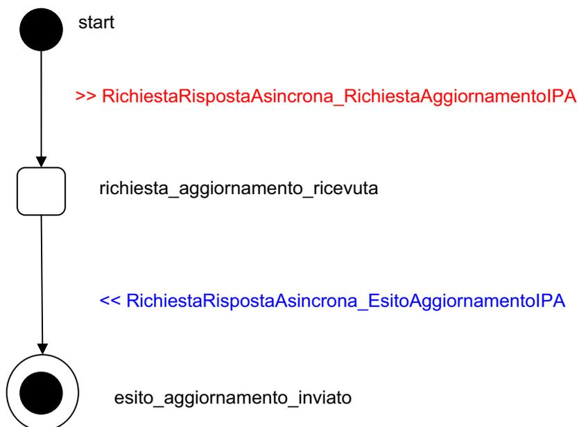
**Figura 21- AggiornamentoIPA – Macchina a stati dell'erogatore**
