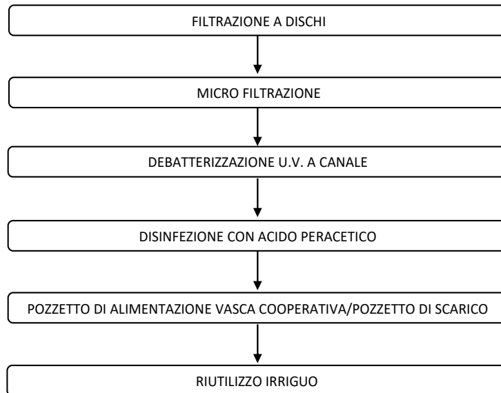
Immagine 2 - Schema a blocchi impianto di affinamento
