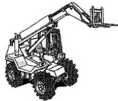
**Gru mobile:** autogrù a braccio in grado di spostarsi con carico o senza carico senza bisogno di vie di corsa fisse e che rimane stabile per effetto della gravità.
