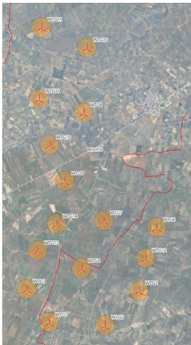
Figura 9 - Planimetria con buffer di 228 m
