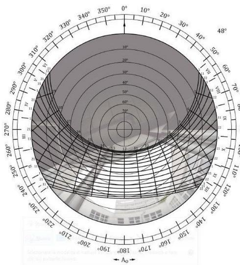
**Figura D.3.3.c. Immagine di tipo grandangolare presa dal punto P guardando verso l'alto, con orientamento a nord in corrispondenza della sommità dell'immagine. Gli edifici schermanti sono ricoperti da un diagramma stereografico delle traiettorie del sole.**
