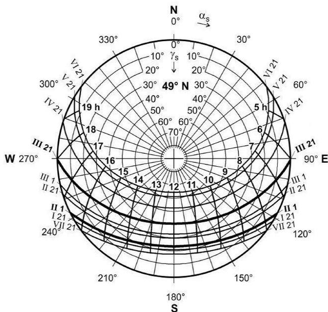
**Figura D.3.3.b. Metodo del diagramma della traiettoria del sole raccomandato per la valutazione dell'esposizione alla luce solare, con la direzione nord posta in corrispondenza della sommità del diagramma**
