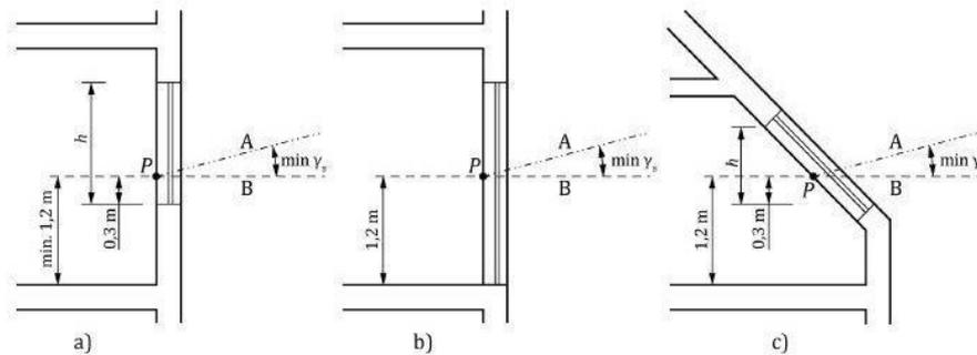
**Figura D.3.3.a. Posizione del punto P di riferimento, in sezione**
