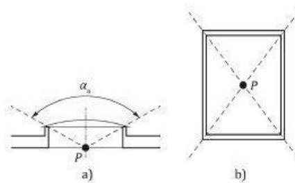
*Figura D.3.3.e. Posizione del punto P, per un'apertura per luce diurna orizzontale*
