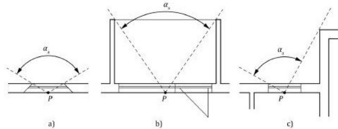
*Figura D.3.3.d. Relazione tra angolo di accettazione  $\alpha_a$  e posizione del punto P, nel disegno in pianta*
