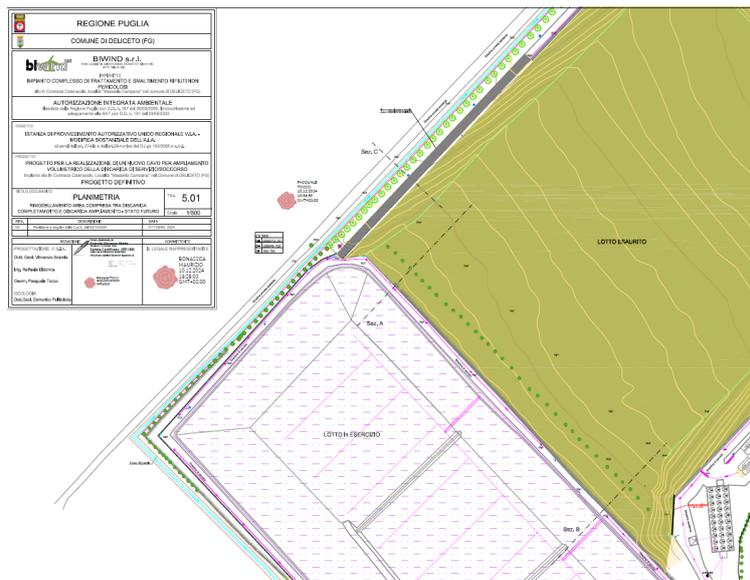
Figura 19: stralcio grafico tratto da elaborato grafico 5.01 “Planimetria rimodellamento area compresa tra discarica completamento e discarica ampliamento stato futuro”
