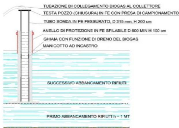
Figura 29: Particolare procedura sollevamento pozzo estrazione biogas
