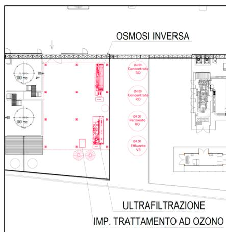
*Figura 17: planimetria dell'impianto di UF e OI*
