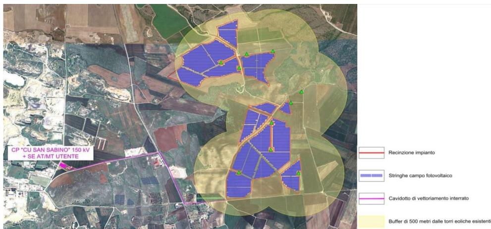
**Figura 04:** Area di Impianto su ortofoto con indicazione degli impianti fotovoltaici esistenti con relativo buffer di 500 m
