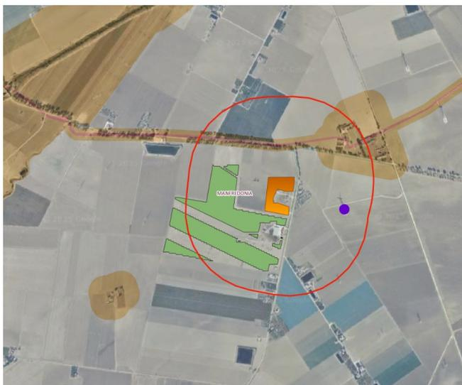
Figura 4 – Sovrapposizione tra il buffer di 500 m (linea rossa) degli impianti esistenti F/CS/E885/6 e F/CD/E885/7 (in arancione) e l'area di progetto Plot 2 (in verde). In viola è indicata una pala eolica vicina E/208/07, situata a 373 m di distanza.
