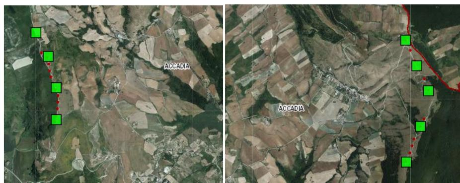
**Figura 7** – Posizionamento degli aerogeneratori rispetto all'impianto eolico esistente che verrà dismesso - fonte <https://webapps.sit.puglia.it/freewebapps/ImpiantiFERDGR2122/index.html>. Posizionamento
