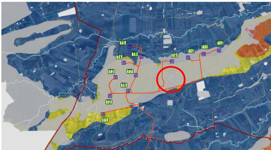
Figura 2 - In grigio aree a pericolosità frane / giallo depositi argillosi / nel cerchio rosso la cava autorizzata, contenuta nel perimetro dell'area APE.
