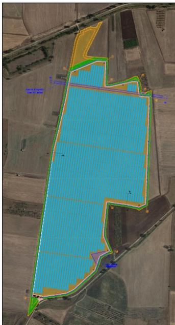
Il layout del progetto prevede l'installazione di file di pannelli posizionati su tracker monoassiali disposti sull'asse Nord-Sud, orientabili sull'asse Est-Ovest. I tracker saranno installati in file parallele, e saranno posizionati con "pitch distance" (distanza dall'interasse dei tracker) pari a 9,50 metri.
