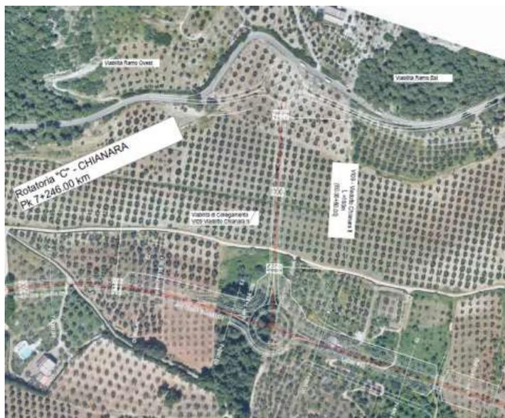
*Sistema di rotondole di connessione tra nuova infrastruttura e SS 89 esistente*
