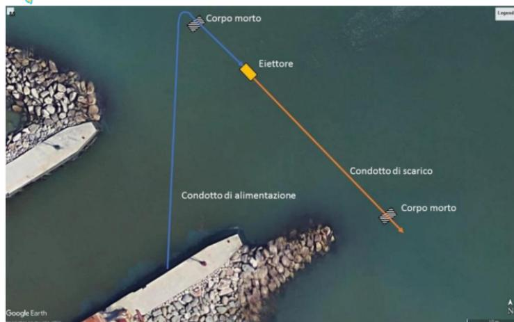
Figura 11.4.1.4 - Modalità di installazione a mare delle tubazioni.
