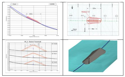
Per l'installazione del pietrame in corrispondenza dell'area di intervento, sarà mobilizzata presso il sito di progetto una nave Fall Pipe Vessel (FPV), già utilizzata nell'esecuzione degli interventi di posa di pietrame nell'area dell'exit-point del microtunnel del Progetto TAP. Questa tipologia di nave ha una capacità di carico tra 15000 e 30000 tonnellate e può installare pietrame per mezzo di un condotto di caduta flessibile "FALL PIPE" o di caduta inclinato.
