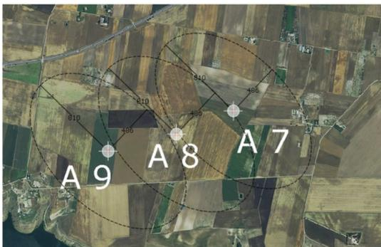
Figura 5 – Schema del layout di progetto con indicazione delle inter-distanze tra gli aerogeneratori
