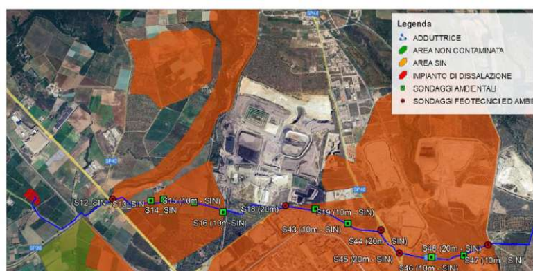
Figura 2: Interferenza tra la condotta adduttrice e l'area SIN ed indicazione dei sondaggi effettuati
