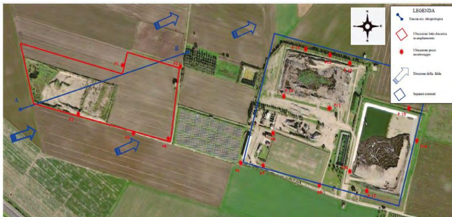
Figura 15: ubicazione pozzi di monitoraggio per il Lotto D
