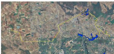
Dalla Carta Idrogeomorfologica risulta che gli aerogeneratori sono vicini a corsi d'acqua e WTG 01 è prossimo a forme di versante: orlo di scarpata delimitante forme semispianate WTG 02 ricade su ripe di erosione fluviale, mentre il cavidotto intercetta corsi d'acqua e ripe di erosione fluviale
