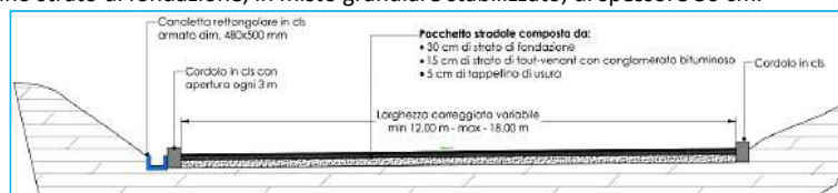
Figura n. 14 - Sezione tipologica strada.
