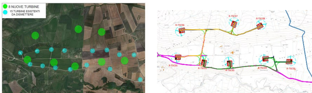
Figura 1 –Aereogeneratori impianto eolico da demolire (celeste) e aereogeneratori impianto eolico repowering (verde)
