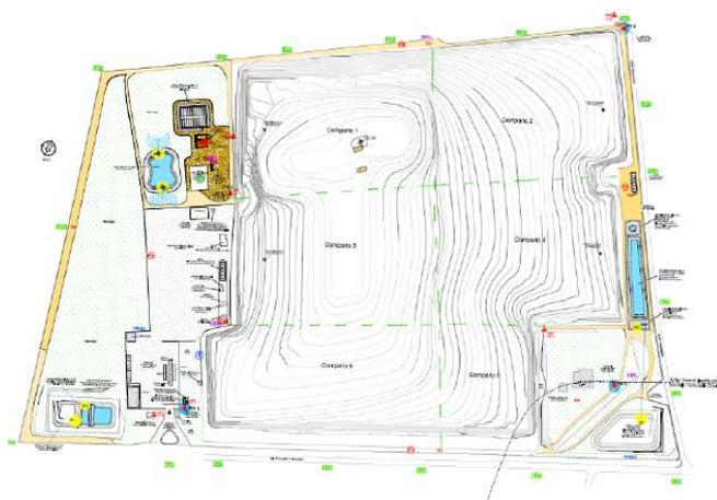
figura 8: Posizione pozzi di monitoraggio - elaborato grafico PR-T12
