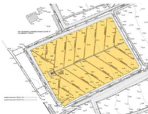
figura 6: Schema esemplificativo drenaggi comparti da 1 a 4
