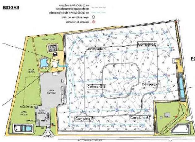
figura 7: Rete captazione biogas esistente
