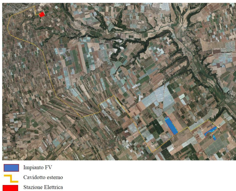
Figura 01: Inquadramento su ortofoto dell'area di ingombro dell'impianto fotovoltaico, del cavidotto e del punto di connessione
