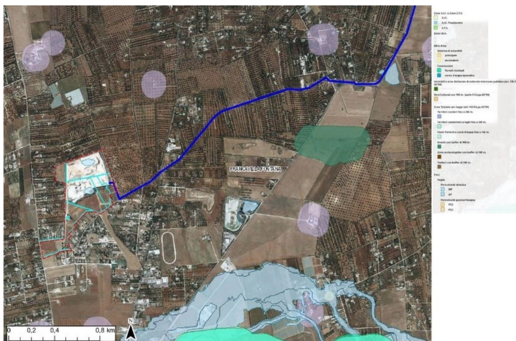
Figura 07: Area dell'impianto Fotovoltaico con cavidotto con indicazione delle aree NON IDONEE ai sensi del R.R. 24/2010
