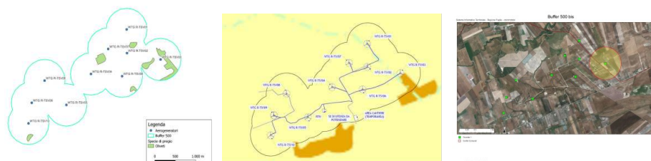
Figura 10 – Essenze di pregio nell'area di indagine - oliveti ricadenti nel buffer di 500 m da ogni aerogeneratore - particolare aerogeneratore WTG R-TSV03
