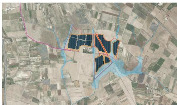
**Figura 6** – Layout Impianto agrovoltaico con sola indicazione dei moduli e dei reticoli idrografici + aree inondabili
