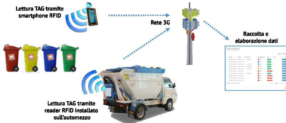
*Architettura del sistema di contabilità dei rifiuti propedeutico per l'implementazione della tariffazione puntuale*
