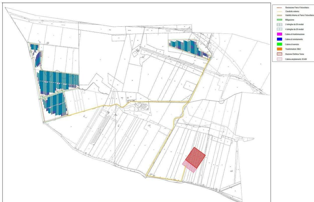
Figura 01: Inquadramento su stralcio catastale dell'area di ingombro dell'impianto fotovoltaico con il relativo cavidotto di connessione
