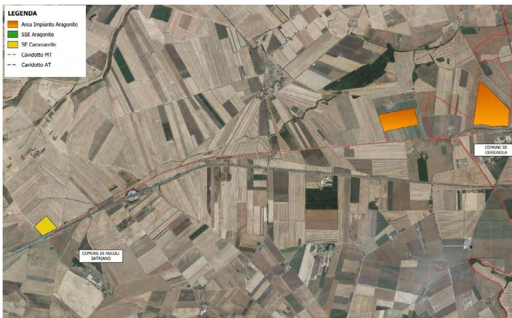
Figura 01: Inquadramento su ortofoto dell’area di ingombro dell’impianto fotovoltaico, del cavidotto e del punto di connessione
