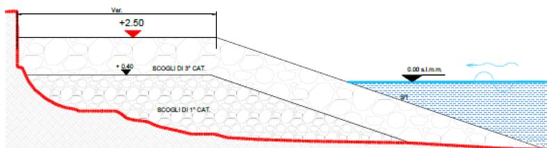
Fig. 3 Sezione tipo della scogliera radente
