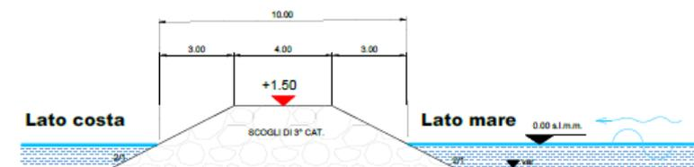
Fig. 6 Sezione tipo del pennello
