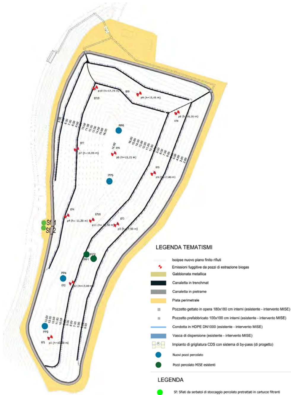
Figura 3: Planimetria di progetto, con l'introduzione della modifica non sostanziale, relativa alle emissioni in atmosfera (Stralcio elaborato grafico "TB.2_rev.2: Planimetria emissioni in atmosfera").
