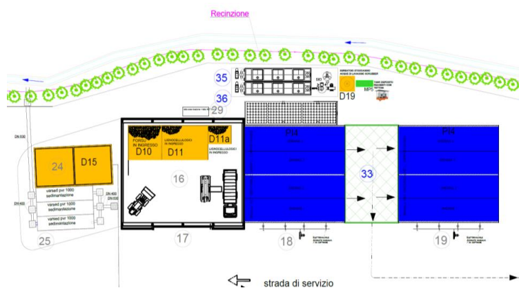
Fig.5 - stralcio estratto da Tav. 08 rev. 3 "Planimetria di progetto: Aree Stoccaggio Rifiuti , MPS e Materie Prime" – Linea di Compostaggio
