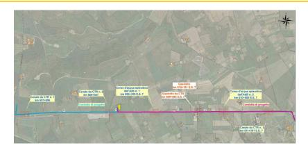
Tali interferenze saranno risolte dal *Proponente* mediante tecniche no-dig (cfr. pag. 24 dell'elaborato A.10 – *Relazione compatibilità idrologica e idraulica*), al fine di ridurre la perturbazione dell'alveo fluviale e di garantire un ricoprimento sopra la generatrice superiore di almeno 1,00 metro.
