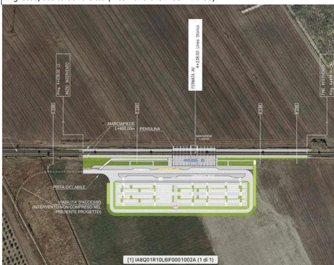
*L’accesso dal fabbricato di stazione al marciapiede est (lato BD) è garantito dalla realizzazione di un sottopasso ciclo pedonale.” [omissis...] Lo scenario di progetto prevede la realizzazione di un sottopasso costituito da uno scatolare in c.a. di dimensioni interne 3,50 (altezza) x 9,60 (larghezza), al fine di consentire l’uso promiscuo con la pista ciclopedonale, in linea con quanto espressamente indicato nel PUMS del Comune di Foggia.*
