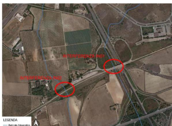
Figura 19 – Indicazione planimetrica delle interferenze del tracciato esistente col reticolo idrografico
