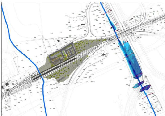
Figura 21 – Valutazione delle aree di esondazione per l'interferenza del tracciato IN01
