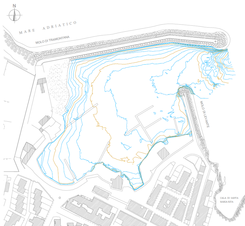
Figura 1 – Planimetria rilievo batimetrico
