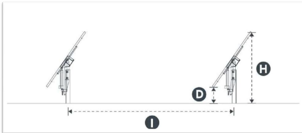
La struttura di supporto del Tracker è realizzata in acciaio da costruzione e progettata secondo gli Eurocodici. La maggior parte dei componenti metallici (trave, pali) è zincata a caldo secondo la norma ISO 1461 o secondo la norma ISO 3575.
