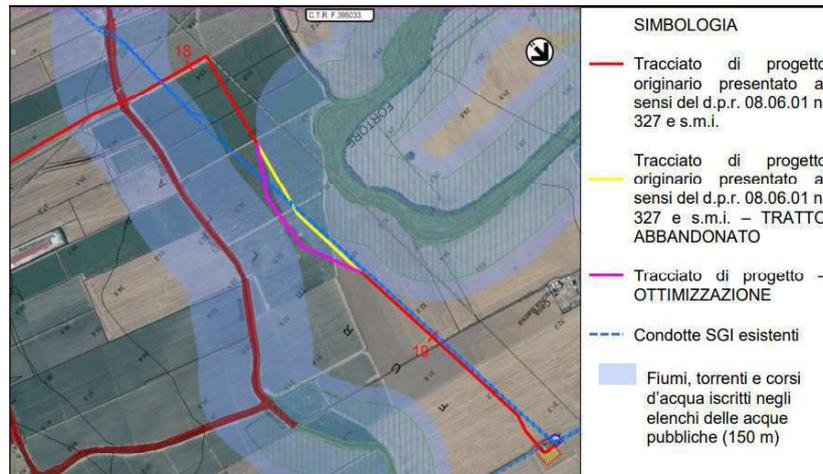
Fig. 1 nuova riconfigurazione del tracciato del gasdotto.
