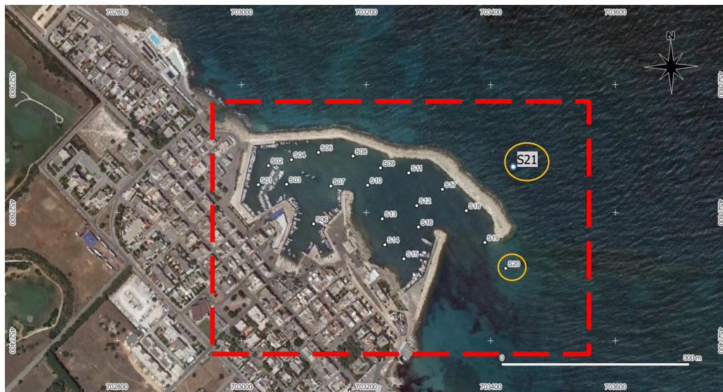
Figura 6-3: Indicazione delle stazioni di sondaggio nella zona di scavo
