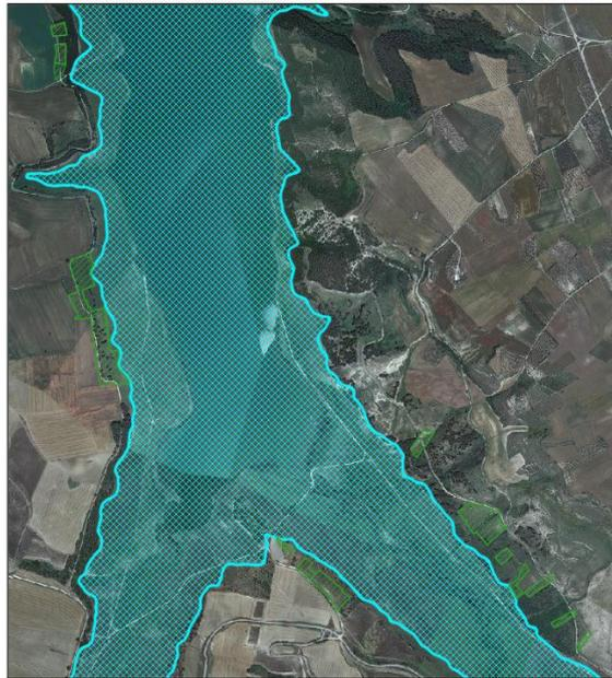
Figura 6 – Superficie esterna al bacino idrografico sotteso dalla diga Soglioccia disponibile per il rimboschimento (in verde)
