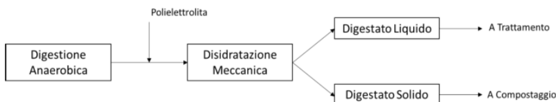
Figura 17: schema di flusso del sistema di disidratazione del digestato
