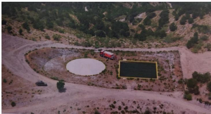
Figura 11.6 Esempio di punto di approvvigionamento idrico utilizzabile dai mezzi ad ala rotante e dai mezzi terrestri.
