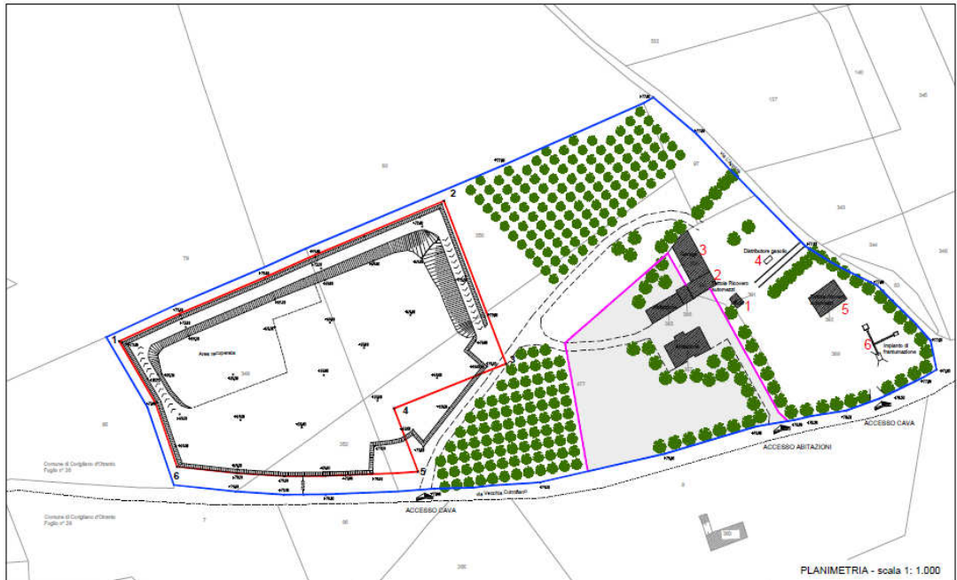
Tav. 19 – Rilievo dello stato dei luoghi con indicazione delle pertinenze, dei fabbricati e degli impianti a servizio della cava
