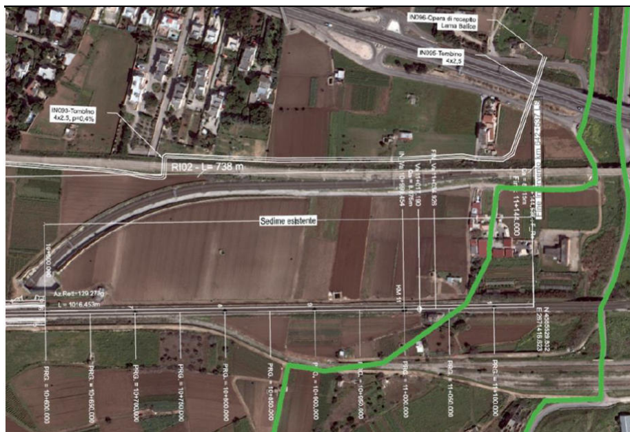
Figura 32 Stralcio della tavola IA7X00R10L6IF0001014A - Planoprofilo su ortofoto binario pari (in verde il perimetro del Parco naturale regionale Lama Balice)
