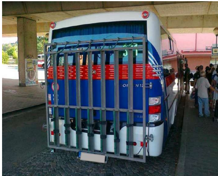
Figura 31 – Supporti posteriori porta bici verticali in Repubblica Ceca (fonte: Cerny and Dagers, 2016)
