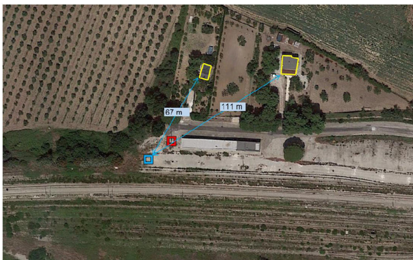
Figura 6-16: Distanze tra antenna nella nuova collocazione (riquadro azzurro) e edifici (in giallo) presenti in prossimità dell'area d'intervento. In rosso l'antenna nella sua attuale posizione (riquadro rosso)
