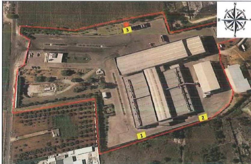
Figura 3.1: Ubicazione centraline di monitoraggio aria
