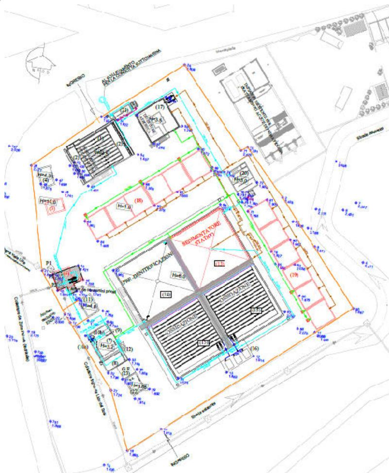
*Planimetria stato di fatto impianto di depurazione con collegamenti idraulici*
